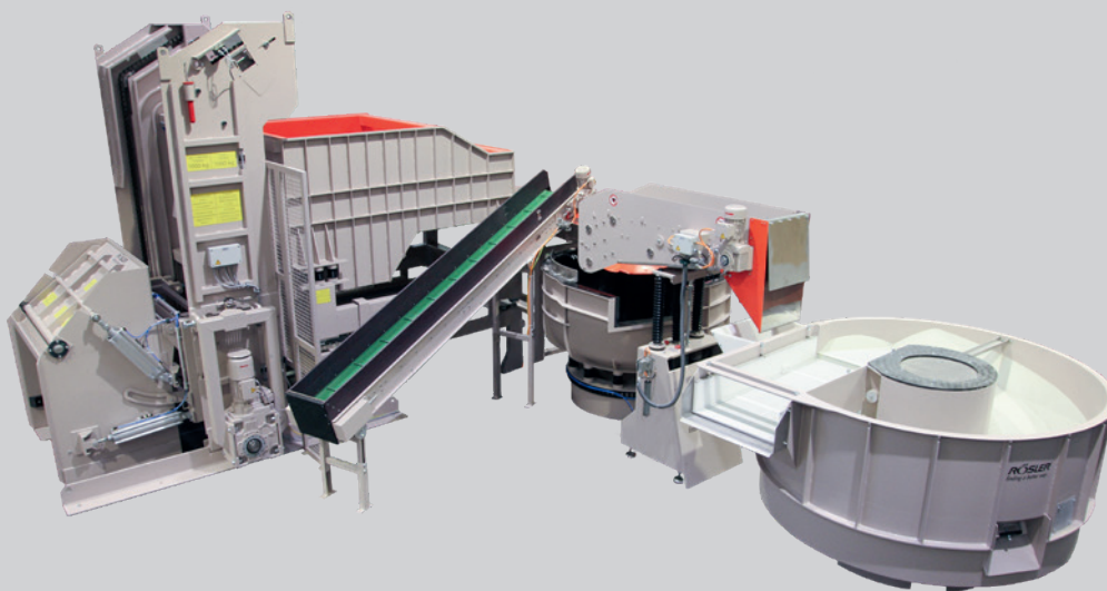
Vibrador rotativo con sistema automático de carga, separación magnética y secado de las piezas de trabajo
