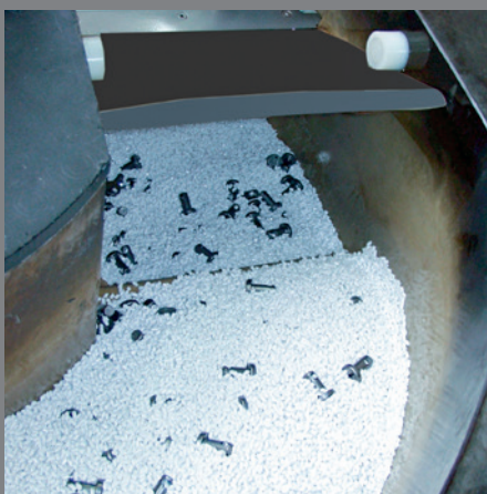
Escalón: facilita la separación de piezas de trabajo planas y evita que se peguen unas a otras
