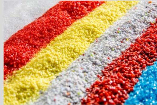
Wir verfügen über ein umfangreiches Sortiment an unterschiedlichen Strahlmitteln für Versuchszwecke und über ein großes Lager an Standardtypen in verschiedenen Korngrößen. Die Entgratanlagen können mit folgenden Strahlmitteln betrieben werden:
