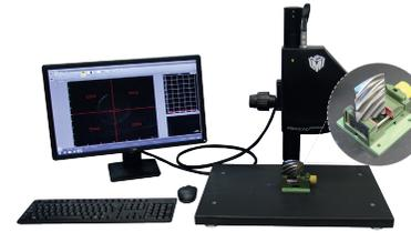
Mit dem zukunftsweisenden, dreidimensionalen Oberflächenmesssystem haben wir die Möglichkeit den Tiefenabtrag auf den Bauteilen exakt zu bestimmen. Selbst bei **mehrfach gekrümmten** Werkstückoberflächen, wie beispielsweise Hypoid Verzahnungen, die mit herkömmlicher Messtechnik nur fehlerbehaftet gemessen werden können, erreichen wir bei der **Bestimmung des Abtrages eine Präzision von 2µm**.
