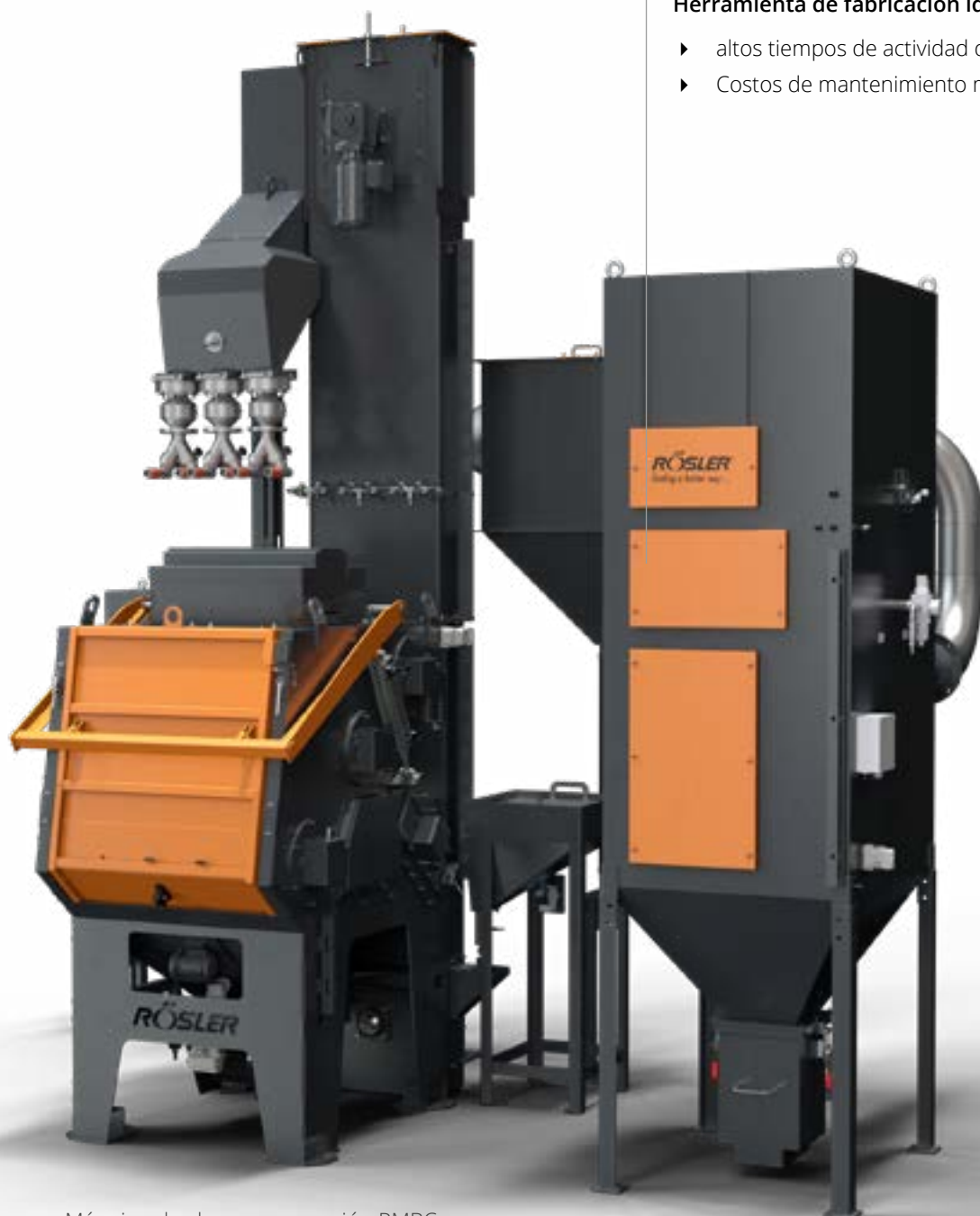
Máquina de chorro por succión RMBC con colector de polvo de cartucho adyacente
