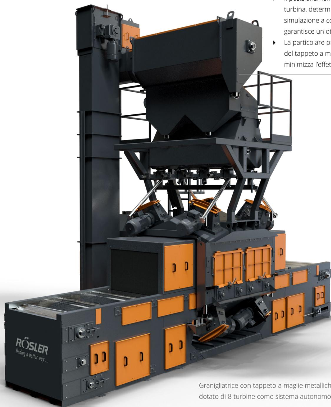
Granigliatrice con tappeto a maglie metalliche dotato di 8 turbine come sistema autonomo
