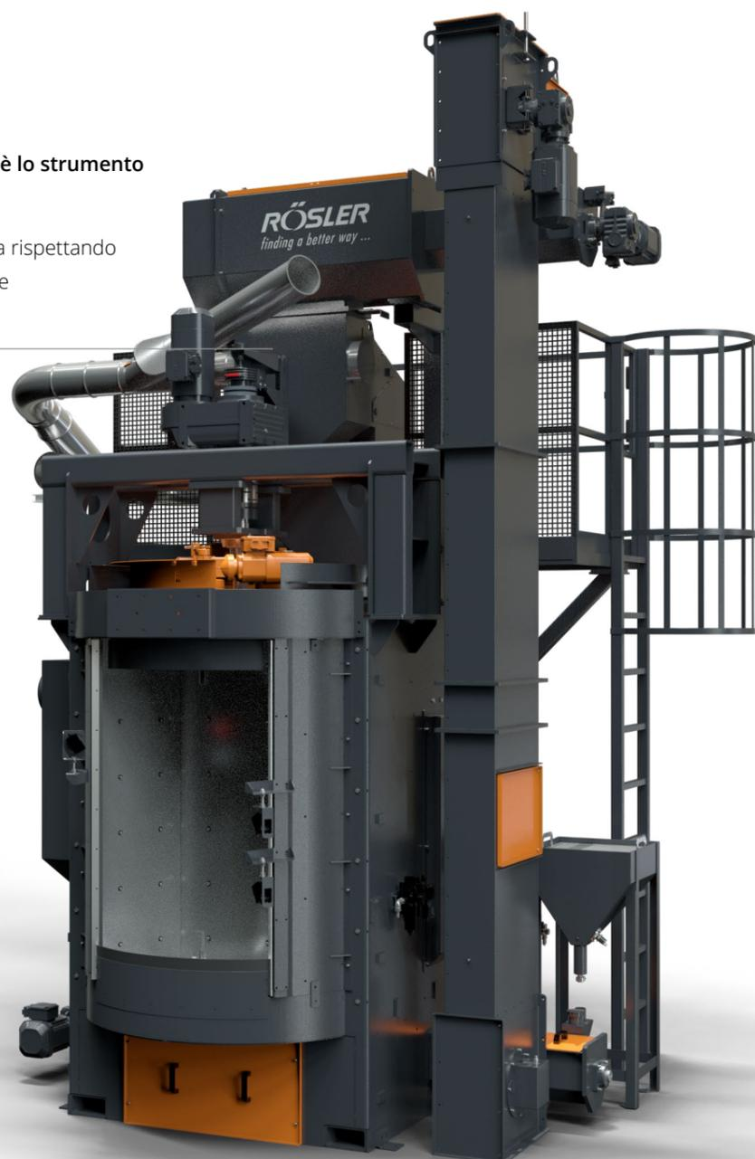
Granigliatrice a camera rotante come sistema autonomo
